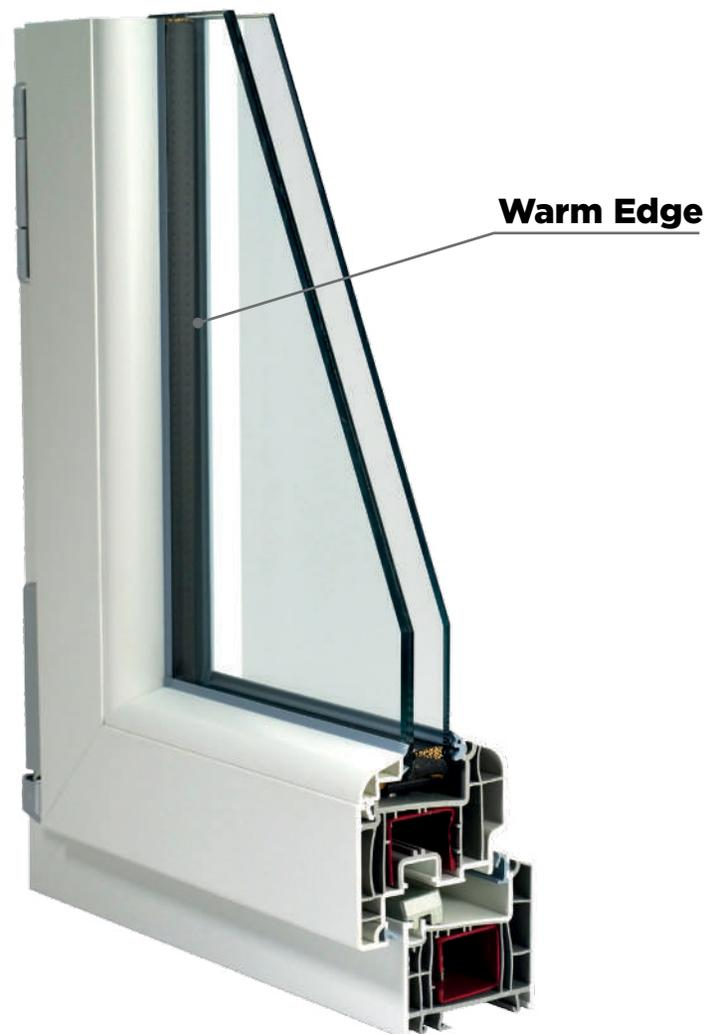
La canalina termica, chiamata anche **Warm Edge**, è un distanziatore realizzato in materiale termoplastico, e quindi isolante, che rende l'infisso più efficiente in termini di trasmittanza termica. Si tratta di un elemento chiave dell'infisso, poiché collega le lastre di vetro in un vetro doppio o triplo e annulla le eventuali dispersioni di calore.
